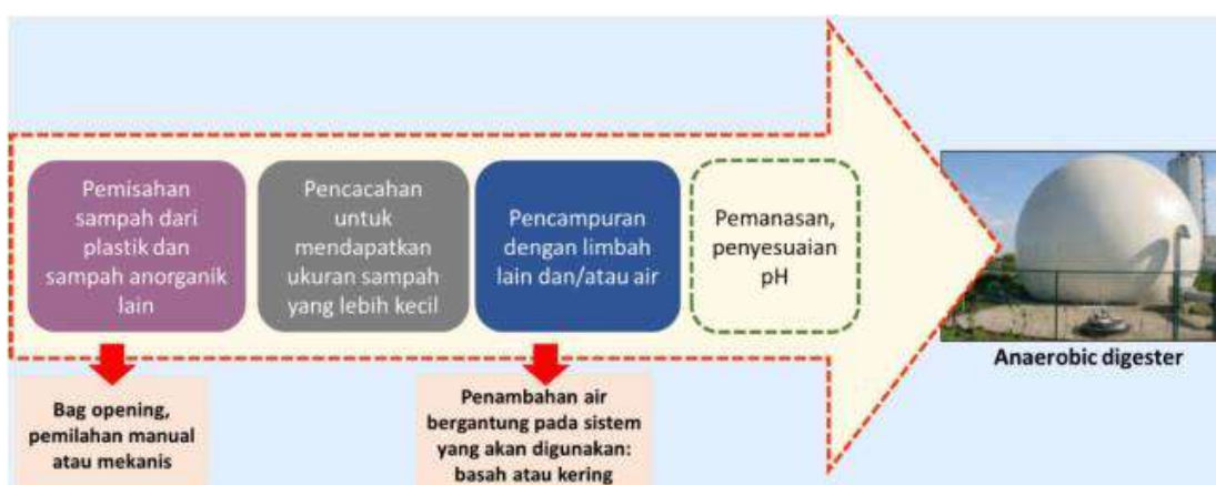
Gambar 4.5. Tahapan Persiapan Substrat Anaerobic Digestion
